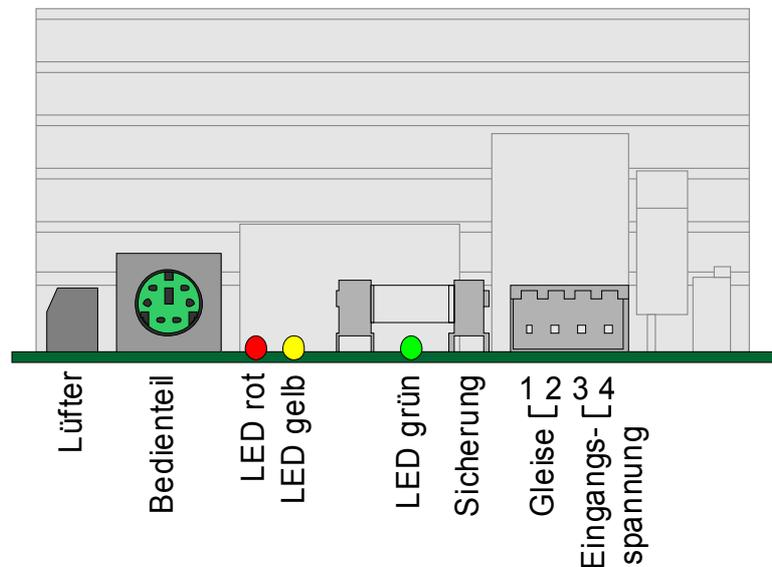
An der steckbaren Anschlussklemme können Litzen bis 1,0mm<sup>2</sup> oder Drähte bis 1,5mm<sup>2</sup> angeschlossen werden.
