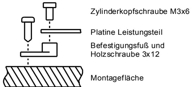
**ACHTUNG!** Der Einbauplatz muss so gewäÙt werden, dass die Luft frei am Kühlkörper und an der Unterseite der Platine zirkulieren kann und kein Wärmestau entsteht. Sollte dies nicht möglich sein, ist der gesondert erhältliche Lüfter (Art.-Nr. 2430) einzubauen.
