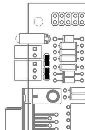
**ACHTUNG!** Das Synchro-Modul darf nur von *einem* SFR2000 versorgt werden! Die Steckbrücken dürfen nur auf *einem* SFR2000 eingesteckt werden! Bei allen anderen SFR2000 dürfen *keine* Steckbrücken eingesteckt sein!
