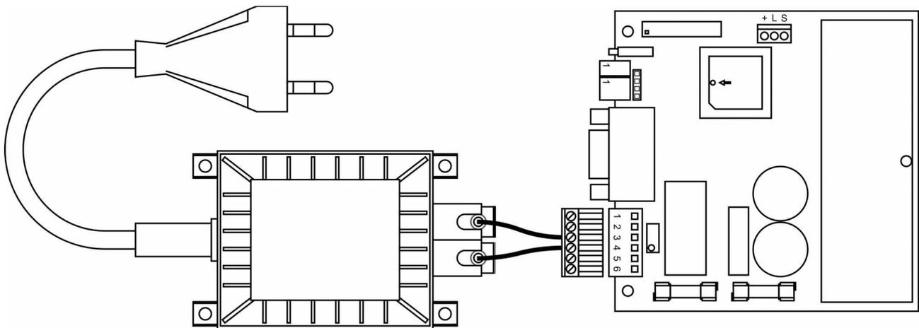
Anschluss der Ausgangsspannung am Beispiel des Fahrreglers SFR2000
