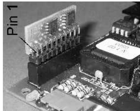
Wenn das Memory-Modul aufgesteckt ist, wird beim Einschalten des SFR2000 das Modul automatisch erkannt und die Meldung "Option 200 Memory" angezeigt. Die Grundfunktionen des SFR2000 bleiben voll erhalten und die Funktionen des Memory-Moduls stehen zusätzlich zur Verfügung.
