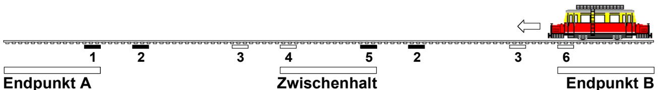
Entsprechend sind hier nur die Kontakte 2 und 5 sowie 2 und 1 vor den jeweiligen Haltestellen wesentlich. Die Kontakte 2 bewirken das Abbremsen auf die langsamere Geschwindigkeit, die Kontakte 5 und 1 bremsen den Triebwagen bis zum Stillstand ab.
