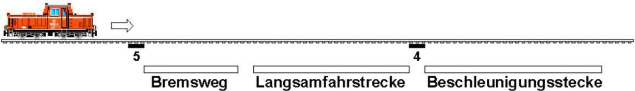
Mit nur zwei Gleiskontakten lässt sich eine Langsamfahrstelle einrichten. Ab Kontakt 5 wird auf die langsamere Geschwindigkeit abgebremst. Nach Überfahren des Kontakts 4 beschleunigt das Triebfahrzeug wieder auf den schnelleren Wert. Soll die Langsamfahrstelle für die Fahrtrichtung nach links gelten, müssen anstelle der Eingänge 4 und 5 die Eingänge 1 und 2 angeschlossen werden.
